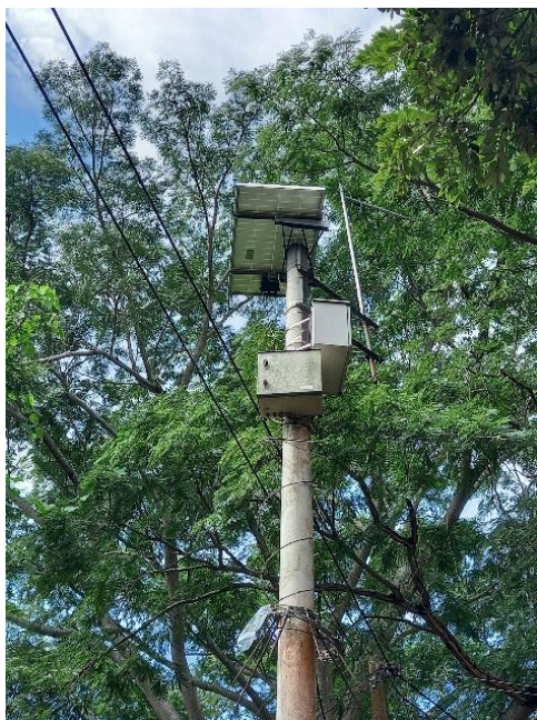
Fotografía 7. Sensor de medición de nivel de río estación Río Cañas.
