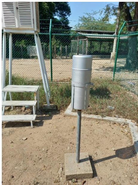
Fotografía 3. Pluviómetro estación Infotec.
