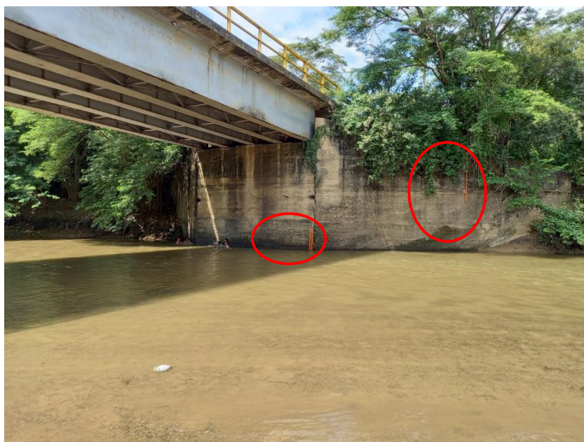
Fotografía 16. Sensor de medición de nivel de río y reglilla, estación Río Tapias.
