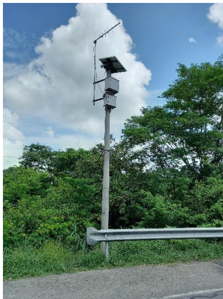
Fotografía 15. Paneles solares, batería y equipos electrónicos estación Río Tapias.
