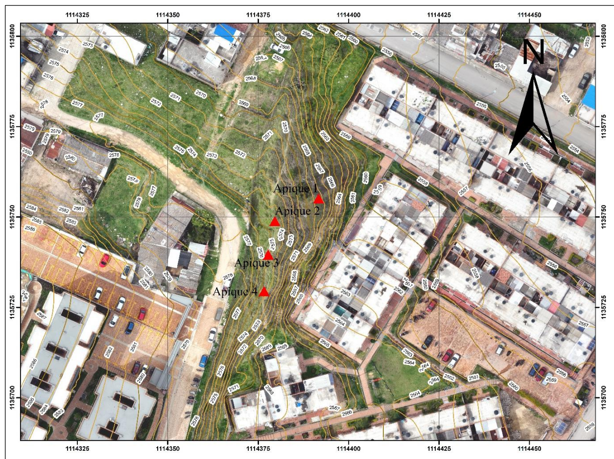
Figura 1. Ubicación de los apiques de exploración geotécnica en el área del proyecto.
