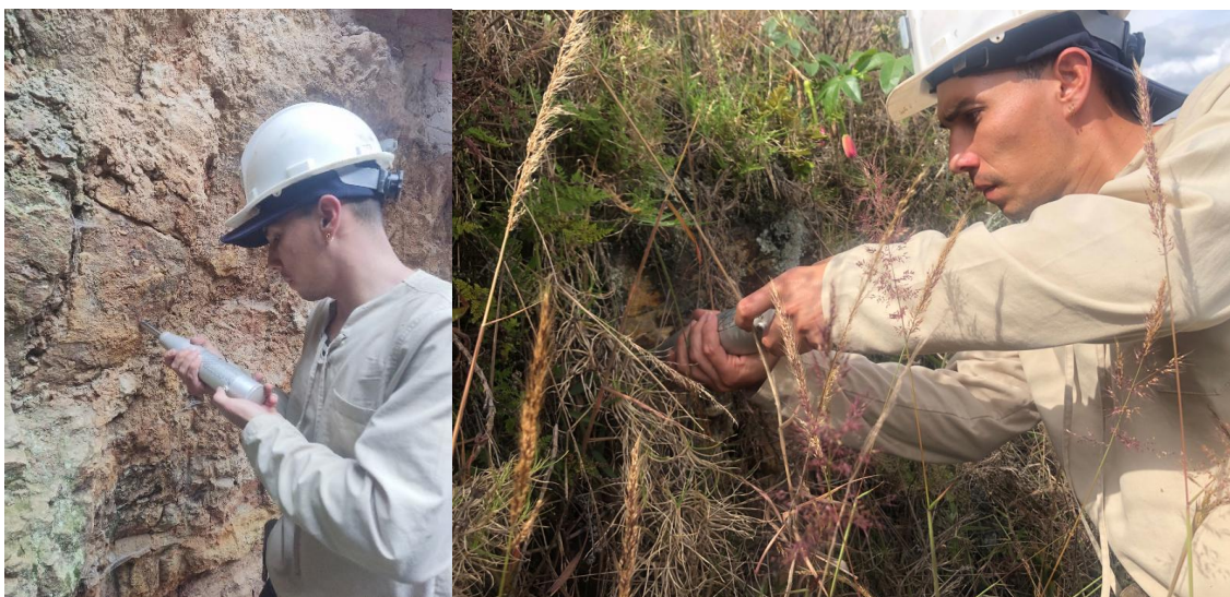
Fotografía 28 y 29. Toma de datos de resistencia a la compresión en campo, empleando martillo de Schmidt o esclerómetro.
