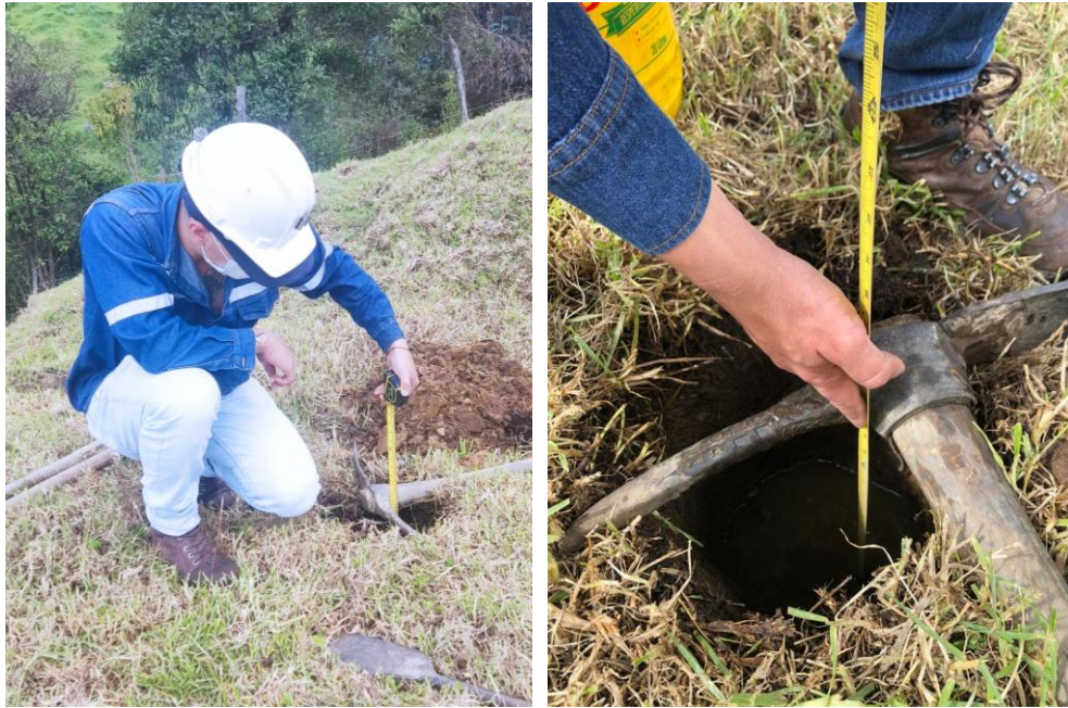
Figura 11: Pruebas de infiltración en campo, método de Porchet para determinación de la conductividad hidráulica k y capacidad de infiltración.
