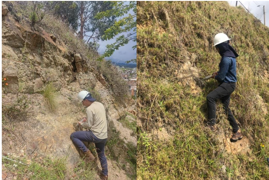
Fotografía 25 y 26. Toma de datos de resistencia a la compresión en campo, empleando martillo de Schmidt o esclerómetro.
