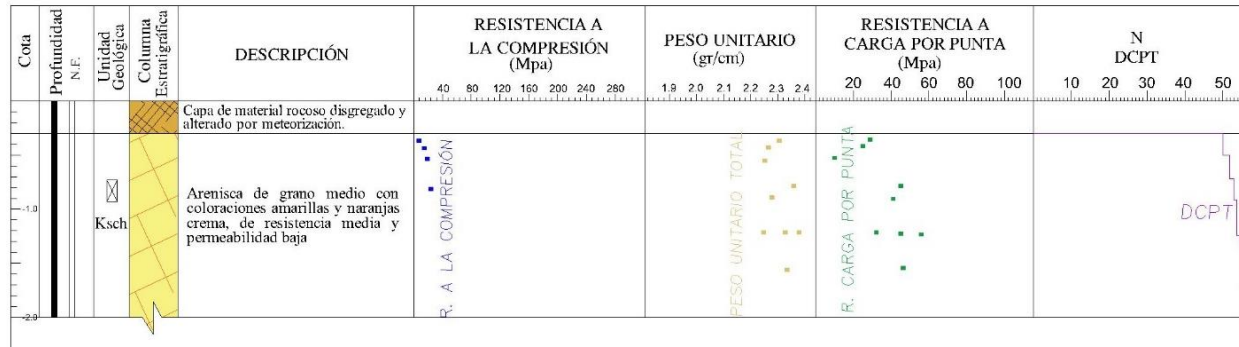
Figura 3. Perfil promedio del macizo rocoso ubicado en el sector La Fuente.
