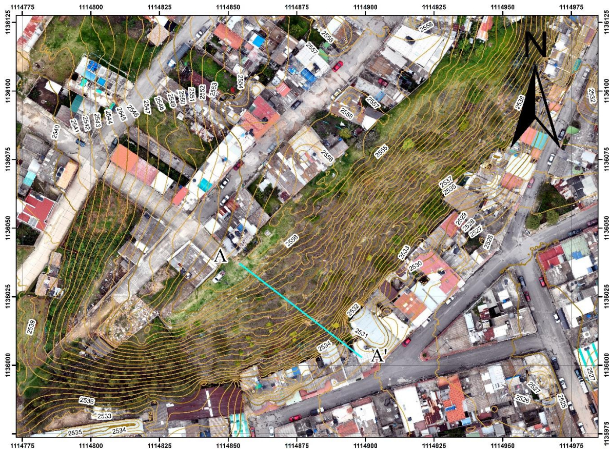
Figura 14. Corte para el análisis cinemático del talud y clasificación SMR del macizo.
