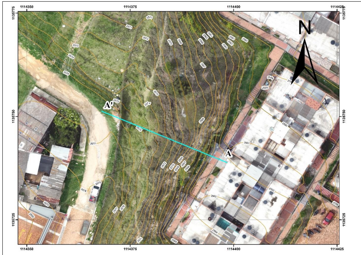
Figura 14. Corte para el análisis cinemático del talud y clasificación SMR del macizo.
