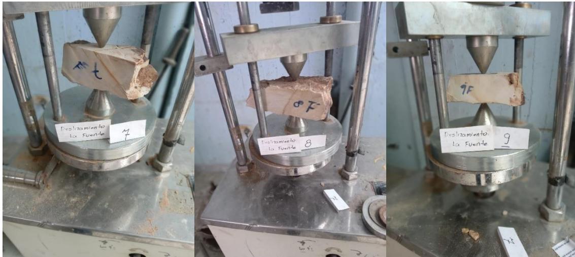
Fotografía 19, 20, 21, 22, 23, 24, 25, 26 y 27. Ensayo de carga por punta en muestras de roca.
