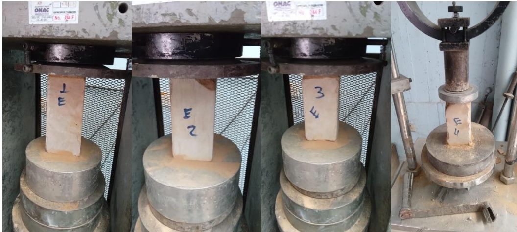
Fotografía 10, 11, 12 y 13. Fotografías de las muestras del macizo rocoso y ensayo de resistencia a la compresión simple.
