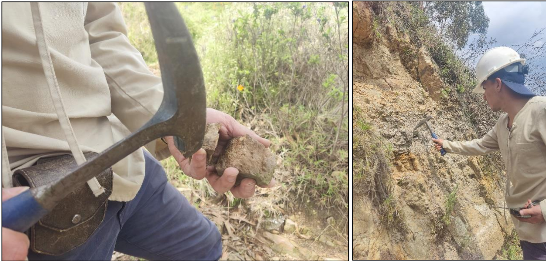
Fotografías 14 y 15. Caracterización manual de muestras para determinar rango de resistencia en campo.
