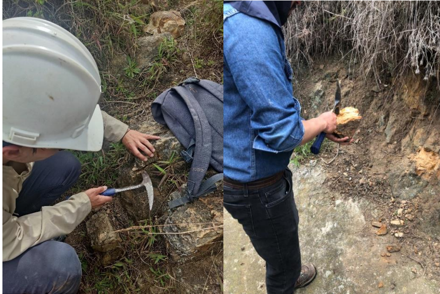
Fotografías 17 y 18. Fotografías de caracterización manual de muestras para determinar rango de resistencia de la roca en campo.
