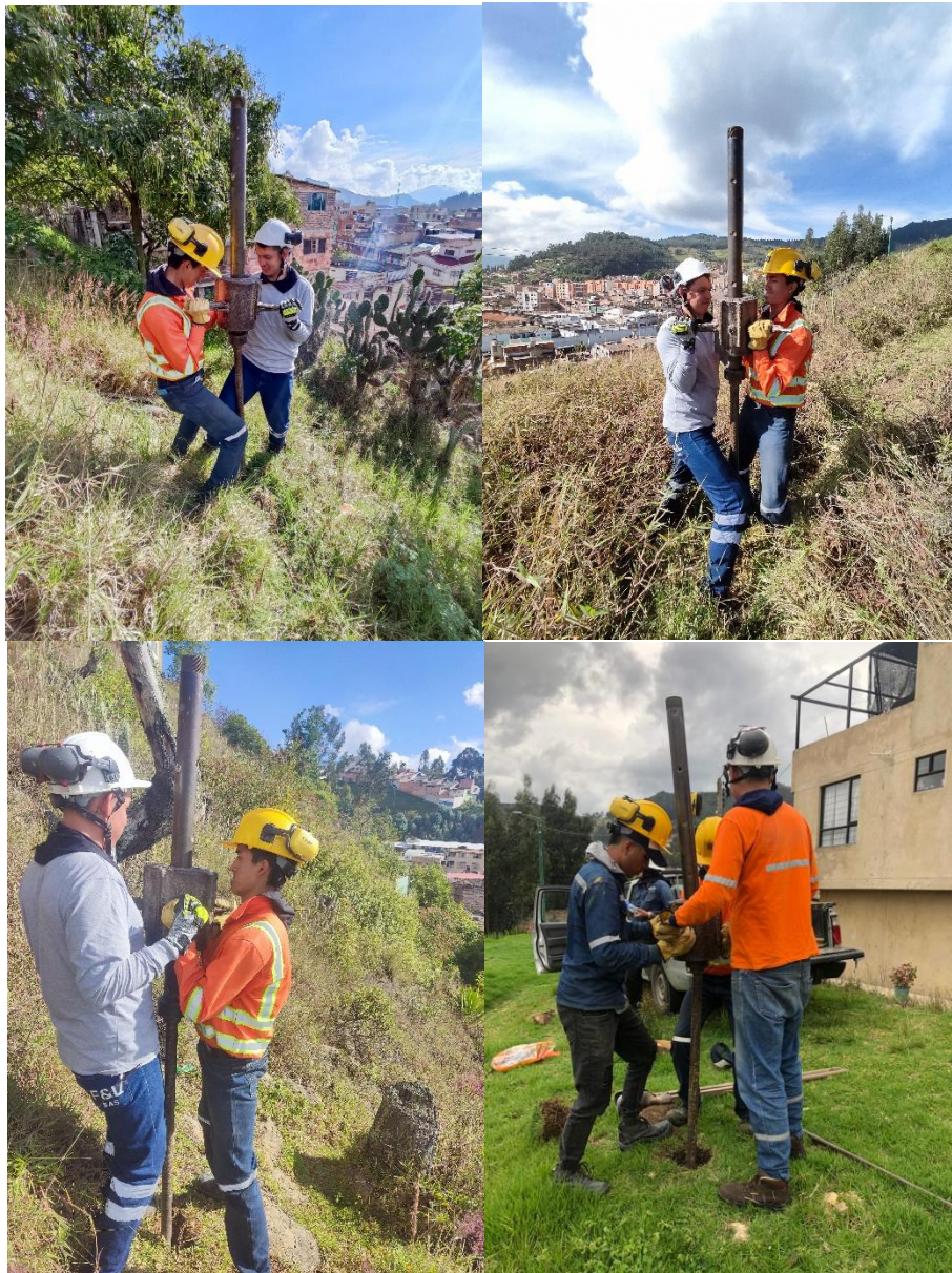
Fotografías 9, 10, 11, 12. Registro fotográfico de pruebas de exploración del macizo rocoso utilizando equipo por el método de percusión en el área del proyecto.
