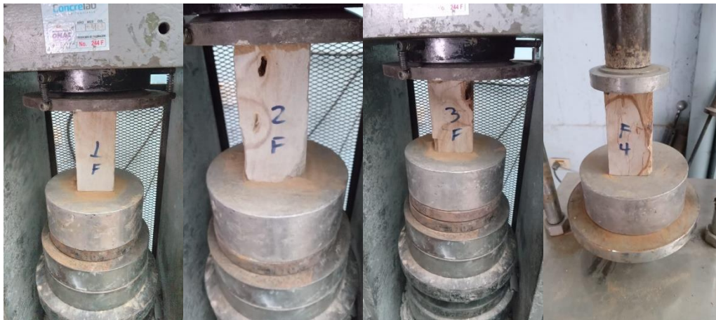
Fotografía 13, 14, 15 y 16. Fotografías de las muestras del macizo rocoso y ensayo de resistencia a la compresión simple.
