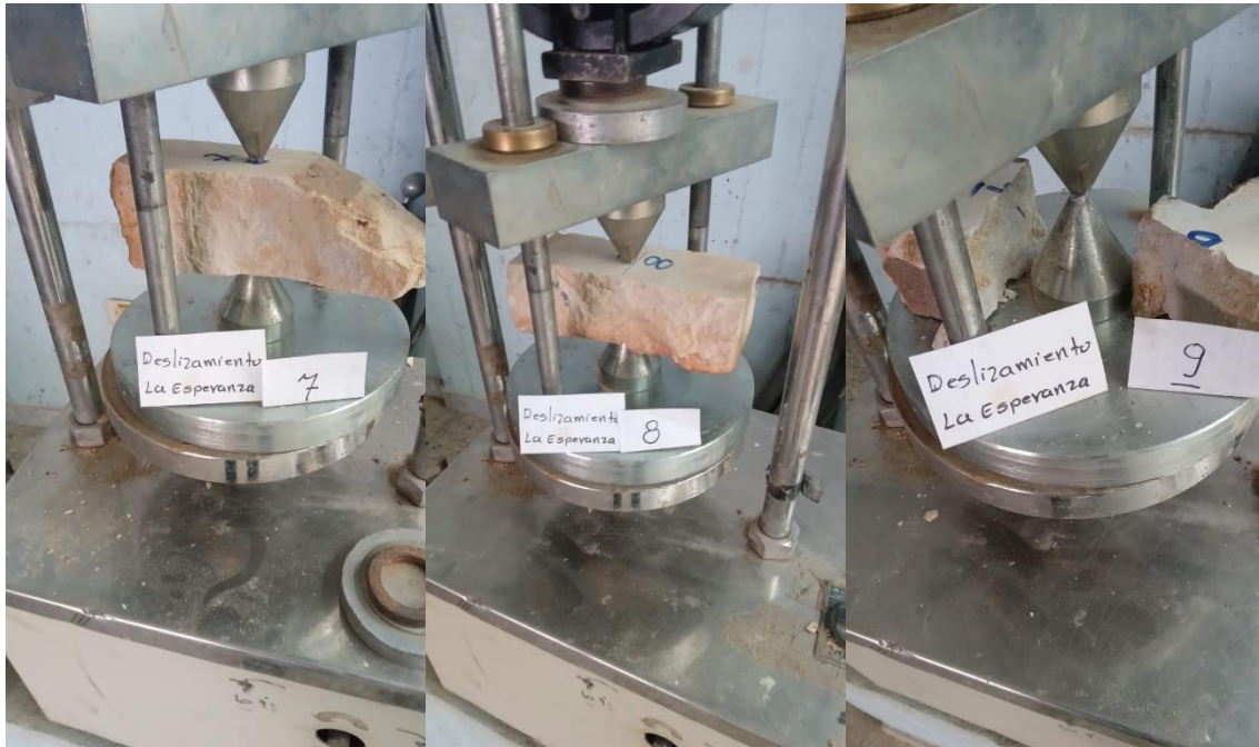
Fotografía 16, 17, 18, 19, 20, 21, 22, 23 y 24. Ensayo de carga por punta en muestras de roca.
