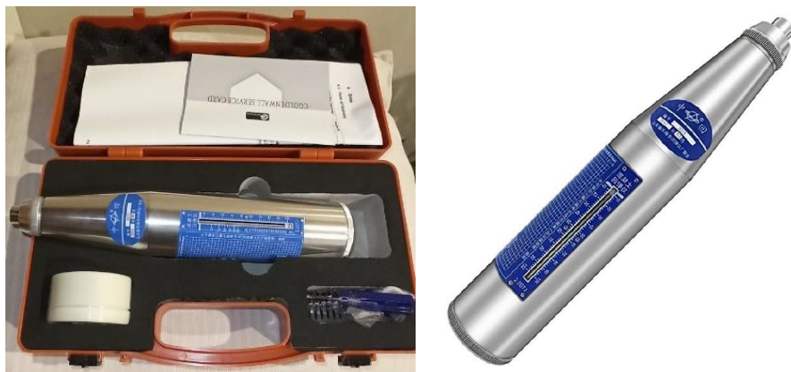
Figura 4. Martillo Schmidt o esclerómetro, empleado para toma de datos de resistencia a la compresión.
