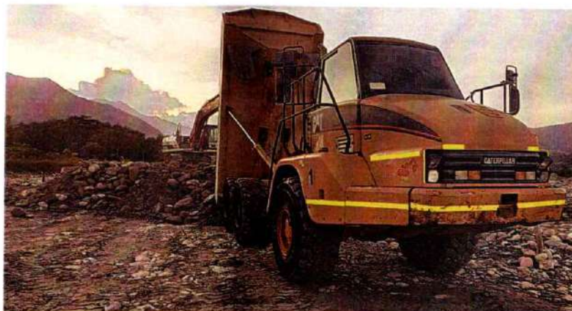
Imagen 522. Dumper Caterpillar 730 #1 realizando actividades de transporte y descargue de material
