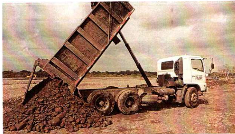
Imagen 304. Volqueta Doble Troque THL 607 realizando actividades de transporte y descargue de material
