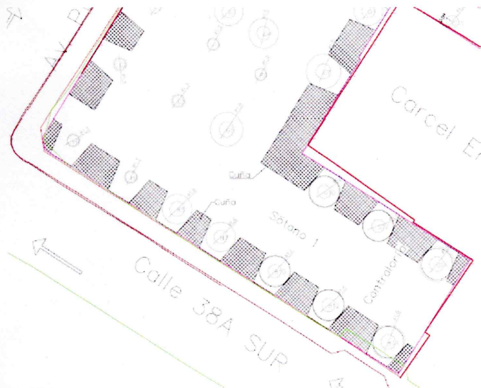
Figura 5. Esquema de la excavación hasta sótano 1.5 para habilitar el trabajo en los sitios de pilas.
