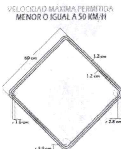
Ilustración 8. Dimensiones señales reglamentarias para obras según la velocidad máxima permitida.
