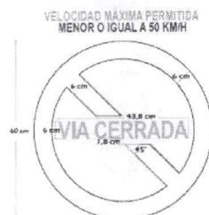
Ilustración 8. Dimensiones señales reglamentarias para obras según la velocidad máxima permitida.
