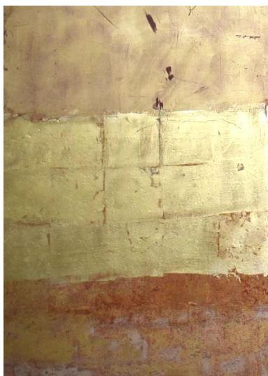
Hojilla de oro de 23,5kl, al centro. (Arriba la hojilla en mejor estado, abajo la hojilla más deteriorada)
