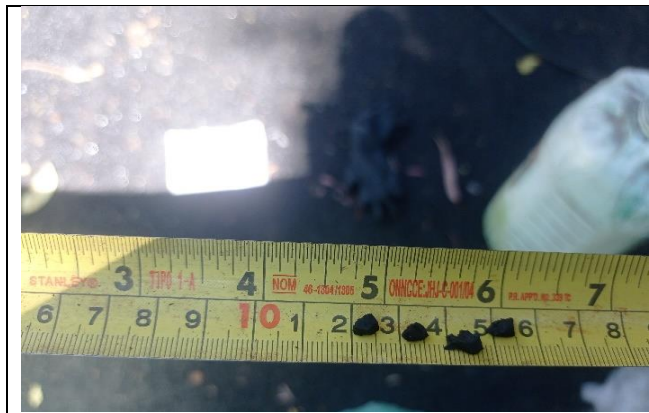
Fotografía N°23. PARQUE SOTAVENTO. COD – 11-965. Se verifica por parte de Interventoría ARQUITECTURA URBANA LTDA, la granulometría del SBR (caucho reciclado), el cual se encuentra entre 4 a 6 mm, de acuerdo a lo establecido en las especificaciones técnicas del INSTITUTO DISTRITAL DE RECREACION Y DEPORTE (IDRD).
