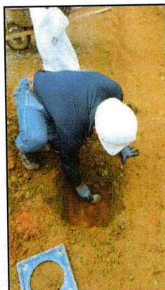
Foto 26 Ensayo de densidades - 2
