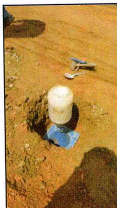
Foto 28 Ensayo de densidades – 4
