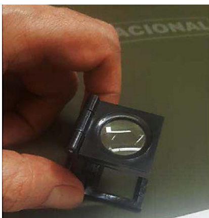
Figura 3. Inspección visual del grabado con lupa cuentahebras
