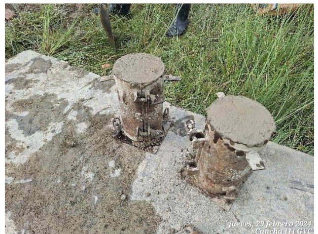
Toma de muestra del concreto para pilotes de la malla contra impacto.
