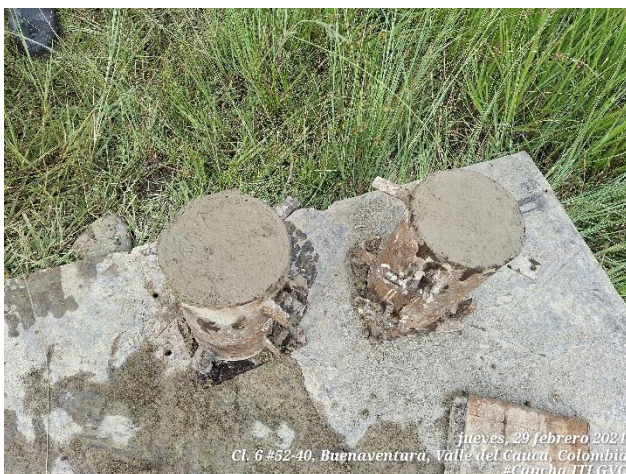
Toma de muestra del concreto para pilotes de la malla contra impacto.
