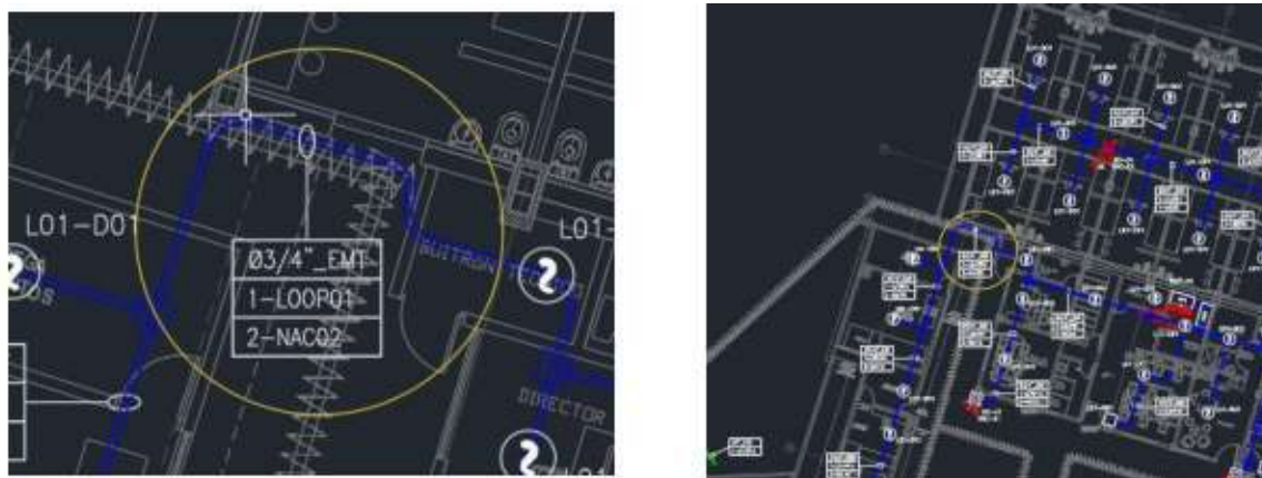
Imagen 1. Ubicación de tubería EMT en infirmería.
