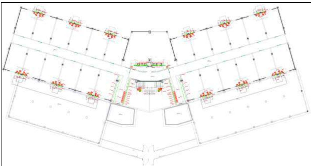
Red de aguas residuales, desagües segundo nivel
