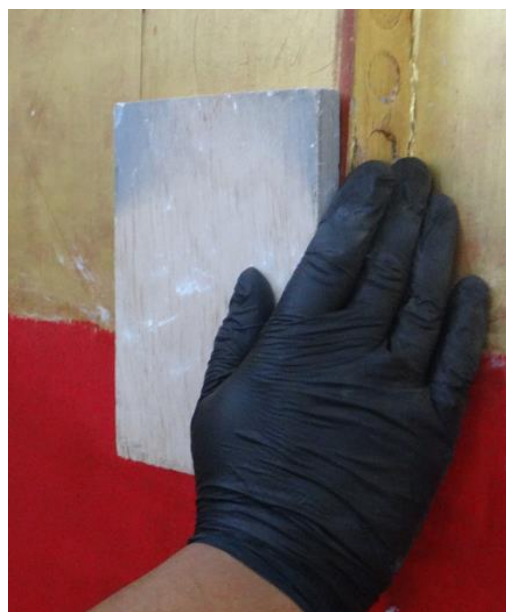
Fotografía 23 Adhesión de chapilla
