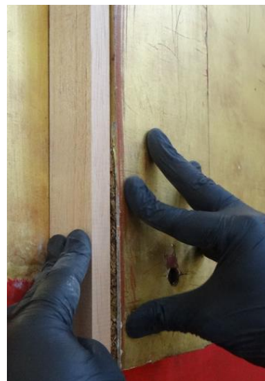
Fotografía 22 Adhesión de chapilla
