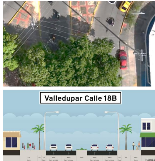
Ilustración 6. Perfil Vial Calle 18b. Fuente propia.
