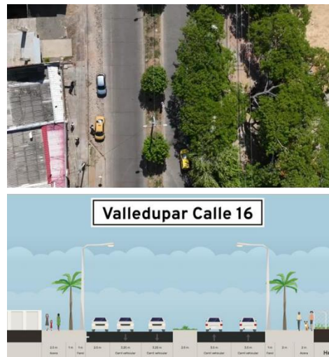
Ilustración 5. Perfil vial Calle 16. Fuente propia.
