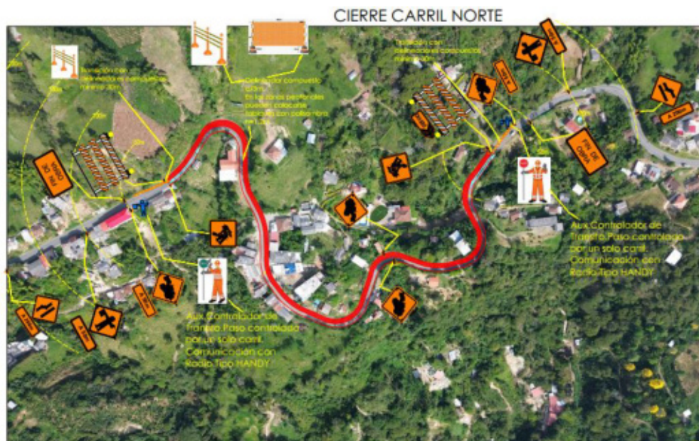
Imagen 6. Esquema de señalización de obra
