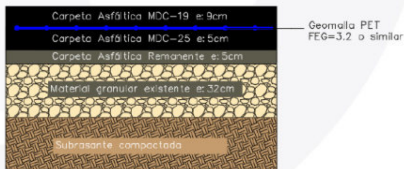
Figura 12. Alternativa 2 Geomalla PET, FEG=3.2
