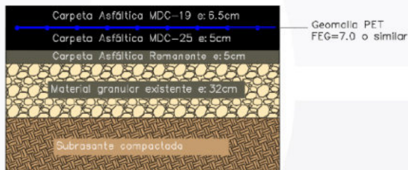
Figura 11. Alternativa 1 Geomalla PET, FEG=7.0
