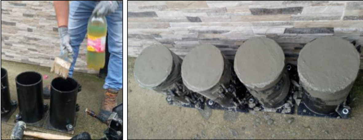
Figura 8. Cilindros para ensayos de resistencia.
