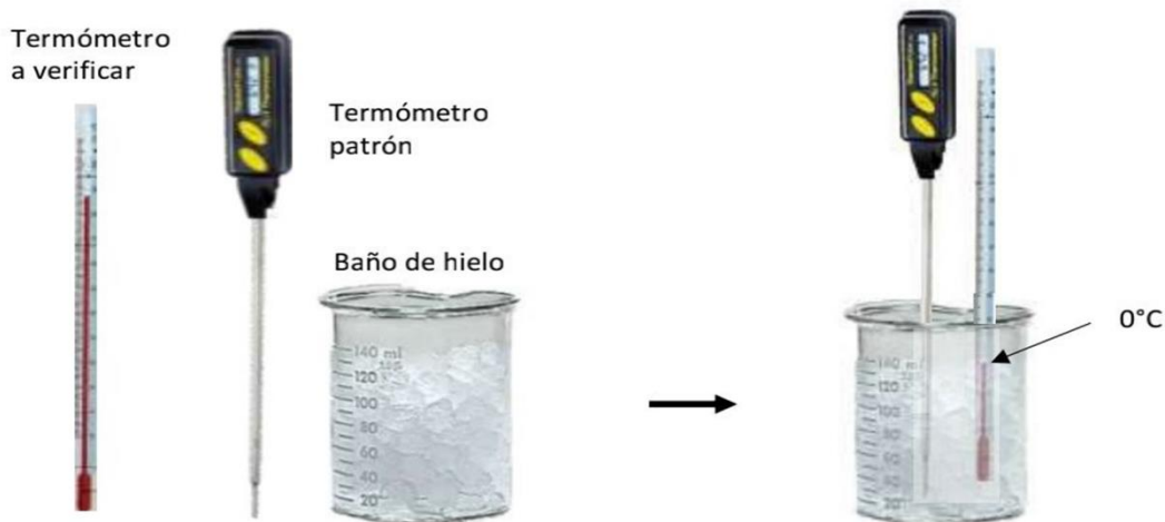
Figura 1 Ejemplo de montaje para verificar temperatura a punto de hielo, la lectura de la temperatura se hace así: primero en el termómetro patrón, en seguida en el termómetro a verificar y para terminar nuevamente en el termómetro patrón.
