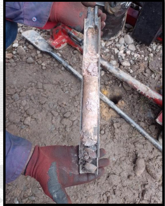
ENSAYO SPT Y RECUPERACION DE MUESTRAS ALTERADAS OBTENIDAS MEDIANTE SPLIT SPOOM
