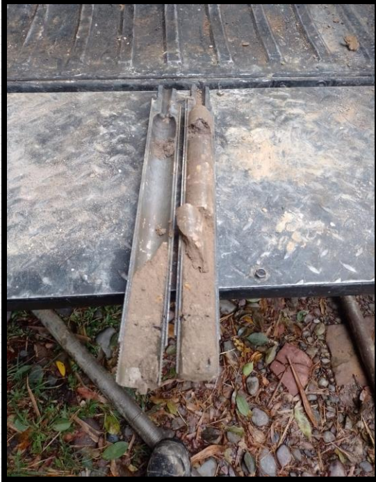
ENSAYO SPT Y RECUPERACION DE MUESTRAS ALTERADAS OBTENIDAS MEDIANTE SPLIT SPOON
