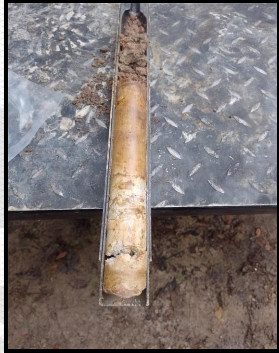
ENSAYO SPT Y RECUPERACION DE MUESTRAS ALTERADAS OBTENIDAS MEDIANTE SPLIT SPOOM
