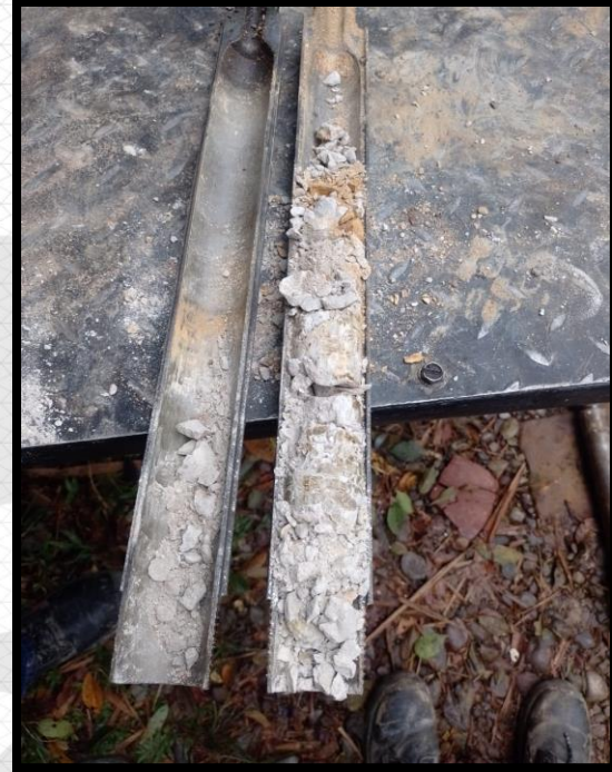
ENSAYO SPT Y RECUPERACION DE MUESTRAS ALTERADAS OBTENIDAS MEDIANTE SPLIT SPOON
