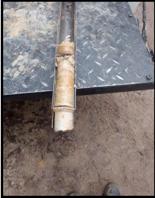
ENSAYO SPT Y RECUPERACION DE MUESTRAS ALTERADAS OBTENIDAS MEDIANTE SPLIT SPOOM
