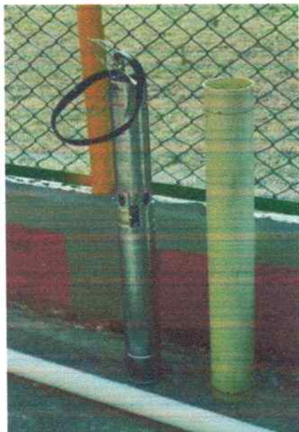
Equipo para instalar con su camisa de refrigeración
