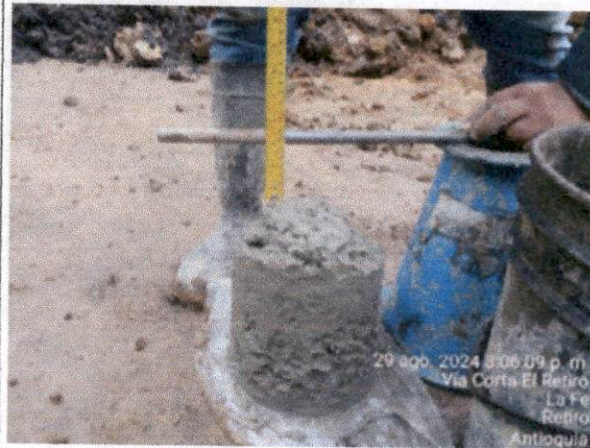
Foto N°46. Verificación de asentamiento concreto vástago módulo 15 muro de contención N°5
