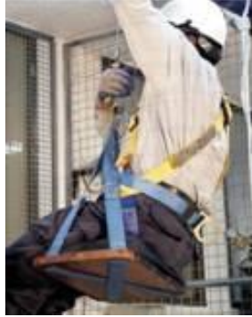
Figura 19. Silla para trabajos en altura en suspensión.
