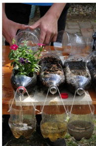
Figura 4. Ejemplo de montaje para experimento simulación de Erosión del suelo
