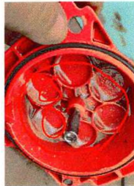
presencia de agua en la unidad
