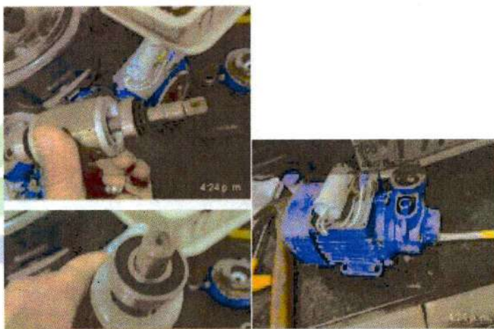
Cambio de rodamiento y sellos bomba pedrollo
