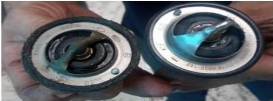
Cambio de termostato
