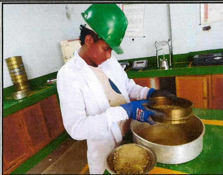
MUESTRA 3 DEL APIQUE No.4 (AP4 -M3), ARCILLA LIMOSA DE COLOR AMARILLO CON TRAZAS DE COLOR GRIS, ENCONTRADA A UNA PROFUNDIDAD DE 1,54 METROS. SE SELECCIONA PASANDOLA POR EL TAMIZ No.40. INV.E-125-13.
