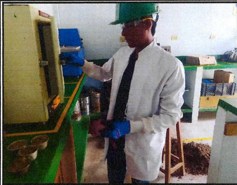
AUXILIAR DE LABORATORIO RETIRA DEL HORNO ELÉCTRICO, LA MUESTRA 2 DEL APIQUE No.1 (AP1- M2) ARCILLA LIMOSA DE COLOR GRIS CON TRAZAS DE COLOR AMARILLO. SE DEJA ENFRIAR LA MUESTRA.
