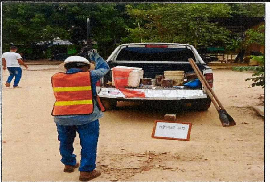
DESPUES DE REALIZADA LA EXCAVACIÓN MANUAL A 0,30 METROS, SE COLOCA EL CILINDRO TOMA MUESTRA DE FILO CORTANTE, EN EL PISO DE LA EXCAVACIÓN PARA TENER MUESTRAS DE SUELOS Y QUE CONSERVEN SU ESTRUCTURA Y LA HUMEDAD.
