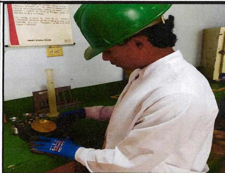
LA MUESTRA SE VA MEZCLANDO CON AGUA HASTA HUMEDecerLA Y QUE QUEDE HOMOGéNEA. SE COLOCA UNA PARTE DE LA MUESTRA EN LA CAZUALA DE CASAGRANDE Y CON EL RANURADOR SE DIVIDA LA MUESTRA EN DOS.. SE INICIA A DARLE LOS GOLPES A LA MUESTRA HASTA QUE CIERRE LA RANURA. SE HACEN MÍNIMO TRES ENSAYOS CON DIFERENTES HUMEDADES .EL NÚMERO DE GOLPES DEBE ESTAR ENTRE(10-20 ; 20-30 - 30-40), CON ESTO SE GRAFICA.
