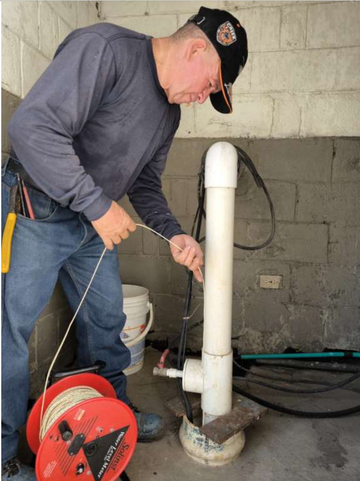
Fotografía Pruebas de bombeo pozo profundo complejo de combustible. Medición de niveles pozo
