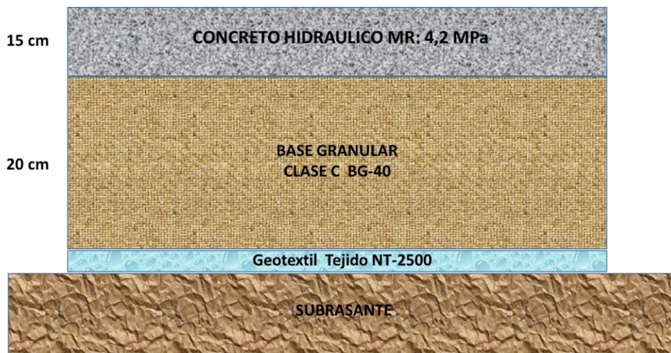
Ilustración 10. Diseño estructura de pavimento
