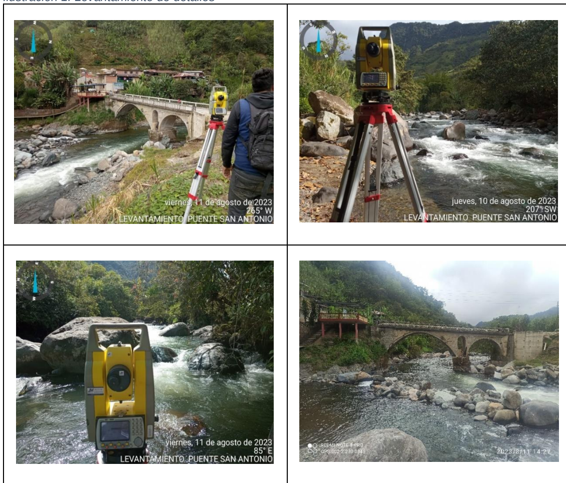
Ilustración 1. Levantamiento de detalles
