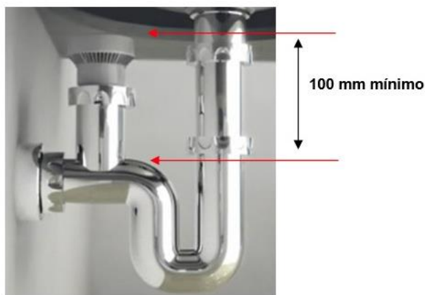
Detalles Instalación válvula Mini Vent de pequeño caudal
