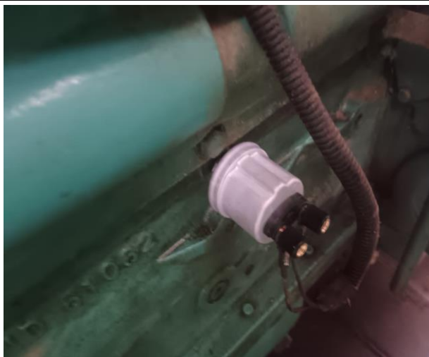
Foto 7. Suministro y cambio de Sensor de aceite
