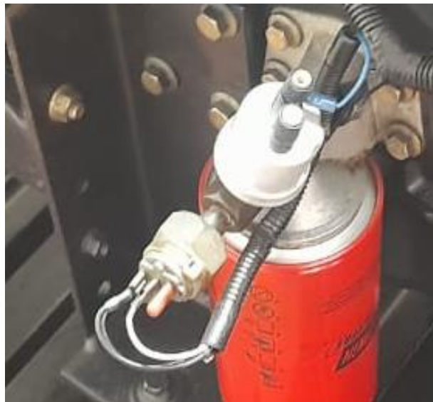
Foto 5. Cambio de sensor de presión de aceite
