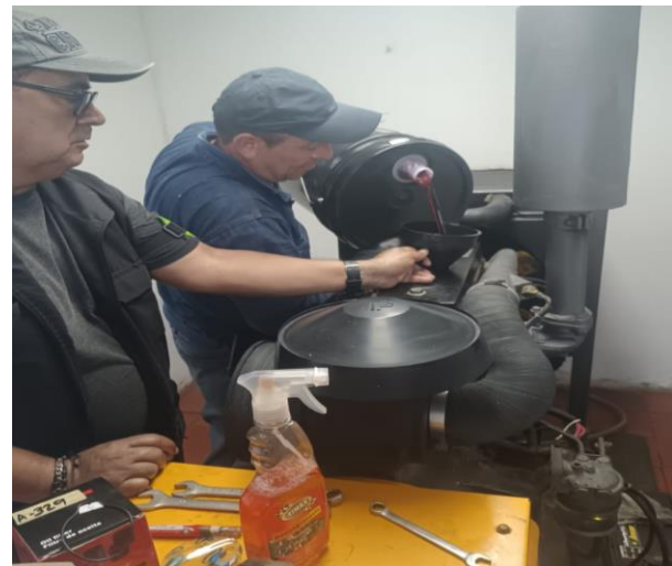
Foto 9. Suministro y cambio de aceite 6 gal
