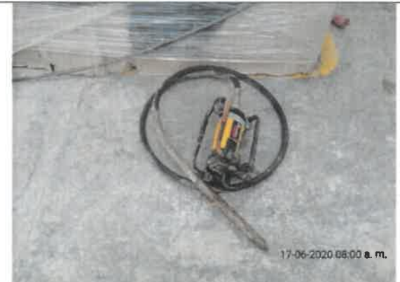
Foto No. 6 . EL CONTRATISTA CONSORCIO PRUNI SEDES 04 utilizó VIBRADOR DE CONCRETO para realizar el vaciado de concreto de los diferentes elementos estructurales como zapatas, vigas de cimentación, vigas aéreas y muros en concreto ubicados del área de archivo y producción.
