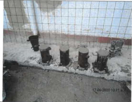
Foto No 24. La interventoría ARQUITECTURA URBANA LTDA se realizó el ensayo según la norma NTC 673 llenado el cono en 3 capas a cada una se le aplican 25 punzones, y posteriormente después de 24 horas de fraguado se desencofraron y se sumergieron en una caneca con agua para garantizar su curado y fraguado óptimo lo cual se debe dejar sumergido hasta la fecha de la toma del ensayo.
