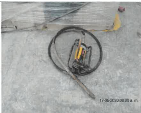
Foto No. 57. Se revisó y verificó equipo vibrador para concreto, en el frente de obra IMPRENTA DISTRITAL
