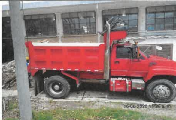
Foto No. 5. EL CONTRATISTA CONSORCIO PRUNI SEDES 04 utilizó volqueta 7 m3 para realizar el retiro de material proveniente de demoliciones del reforzamiento estructural del área de producción..
