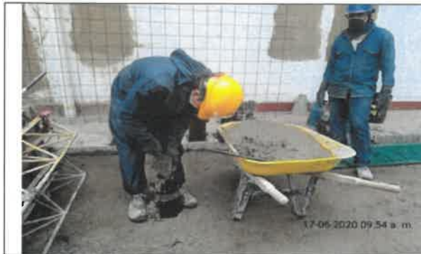
Foto No 21. La interventoría ARQUITECTURA URBANA LTDA se realizó el ensayo según la norma NTC 396 llenado el cono en 3 capas a cada una se le aplican 25 punzones, y se retira el cono lentamente para realizar su lectura en pulgadas.
