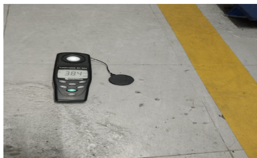
Foto 3. Iluminación en sala de máquinas es inferior a 200 Lux
