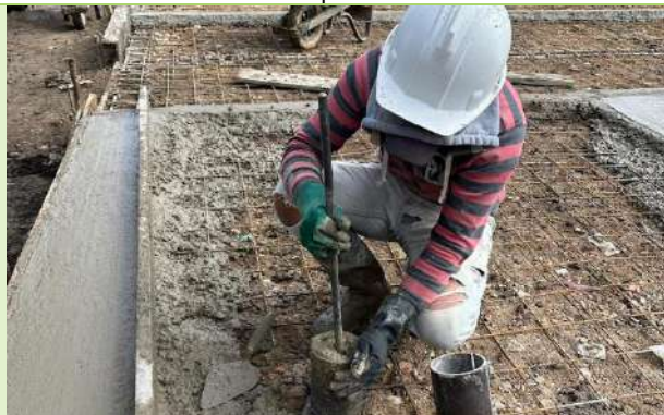
Ilustración 67. Toma de muestras de acuerdo la norma INV E-410
