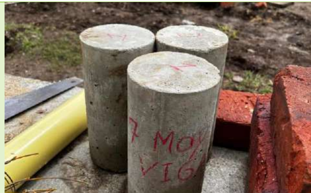
Ilustración 64. Muestras de concreto para ensayo de compresión
