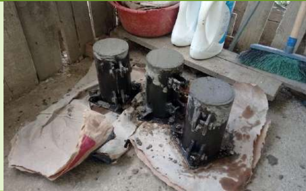
Ilustración 66. Muestras de concreto para ensayo de compresión
