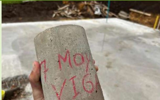
Ilustración 65. Muestras de concreto para ensayo de compresión
