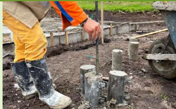
Ilustración 62. Toma de muestras de acuerdo la norma INV E-410
