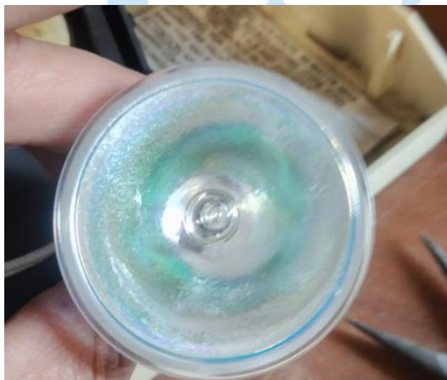
HALOGEN LAMP DESGASTADA
