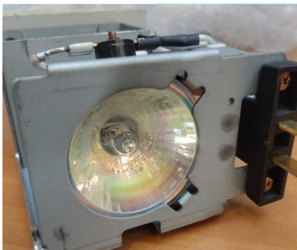
HALOGEN LAMP DESGASTADA
