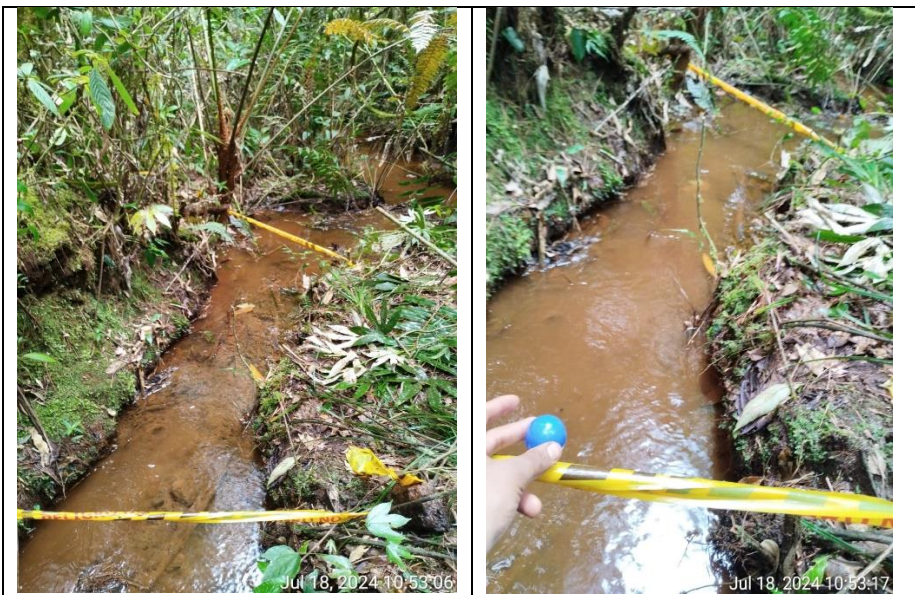
Medición de la velocidad por método del flotador
