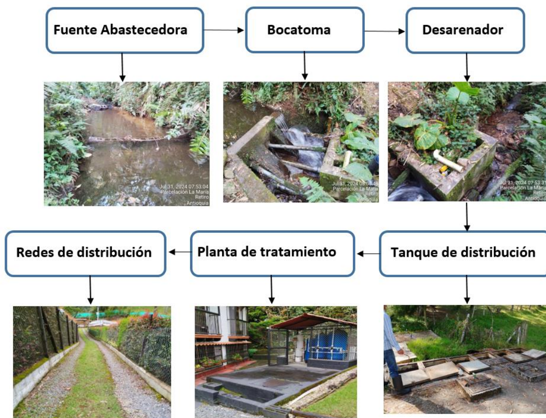
Ilustración 3 Esquema PTAP Altos del Cauce
