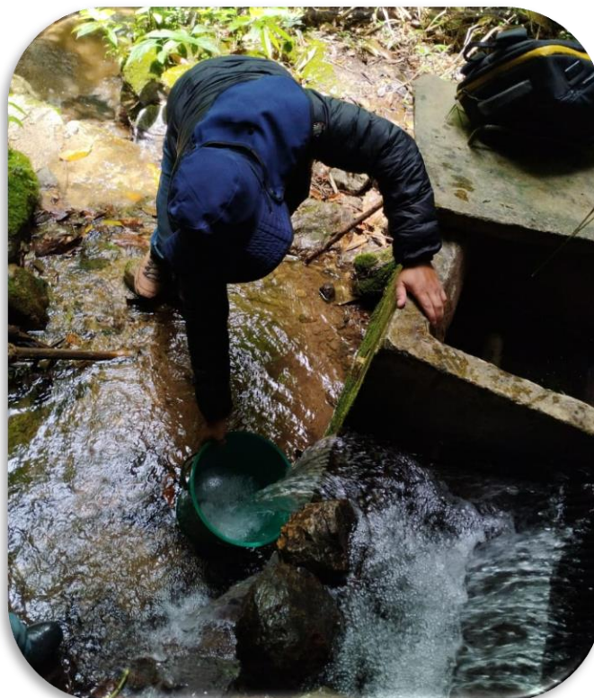
Fotografía 5 – Recolección del fluido en recipiente de 20L
