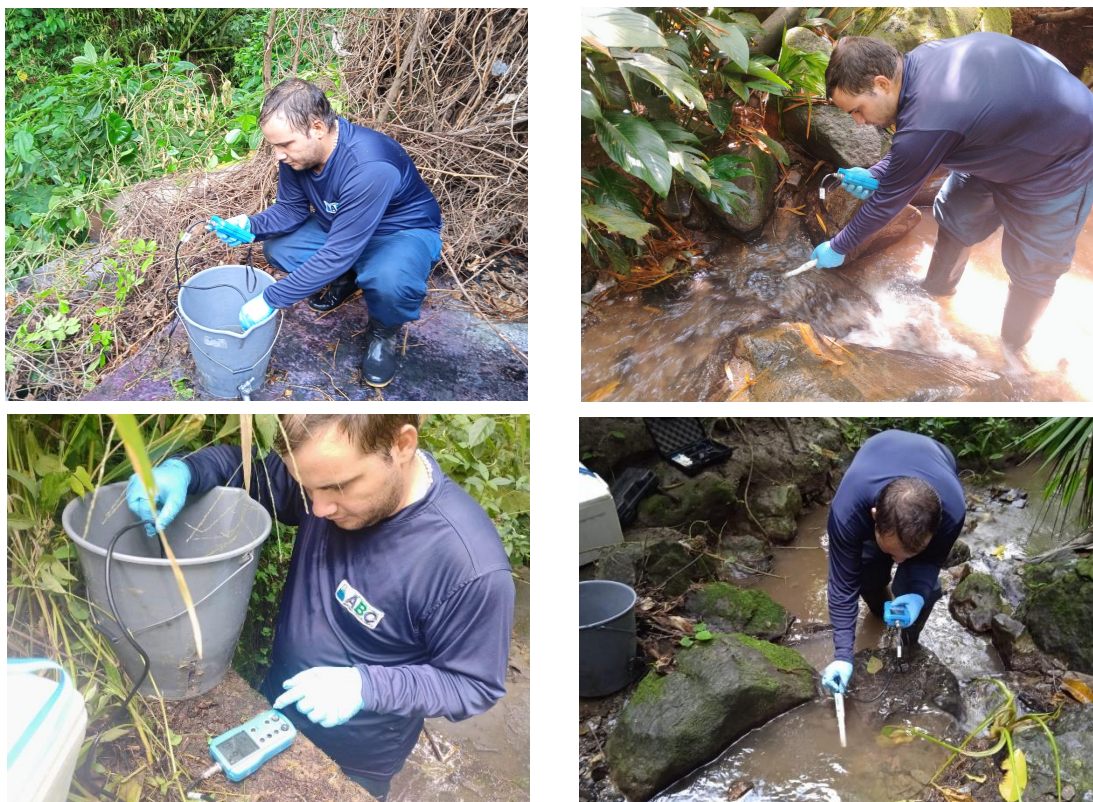
Foto 8. Medición de Caudales
