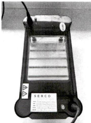
Figura 5. Cámara lista con el gel adentro. Las muestras se observan de color morado por el buffer de carga dentro de cada uno de los pozos. Pozos orientados hacia el lado negativo para que las muestras corran hacia el positivo
