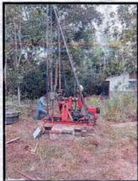
ENSAYO SPT Y RECUPERACION DE MUESTRAS ALTERADAS OBTENIDAS MEDIANTE BARRENO DE PERFORACION MECANICA POR ROTACIÓN, SONDEO 1.
