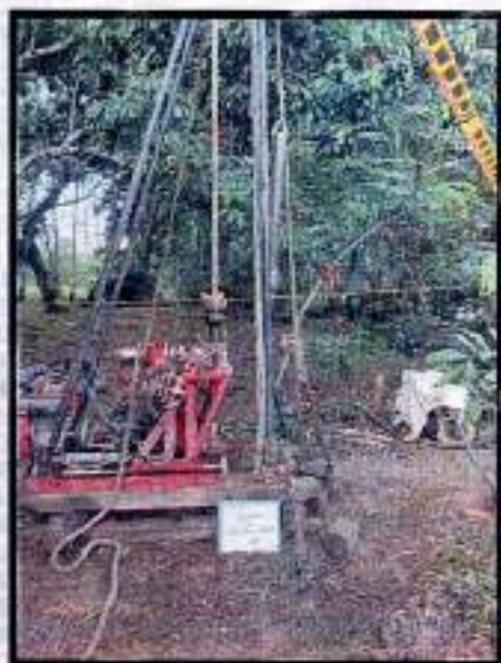
ENSAYO SPT Y RECUPERACION DE MUESTRAS ALTERADAS OBTENIDAS MEDIANTE BARRENO DE PERFORACION MECANICA POR ROTACIÓN, SONDEO 2.
