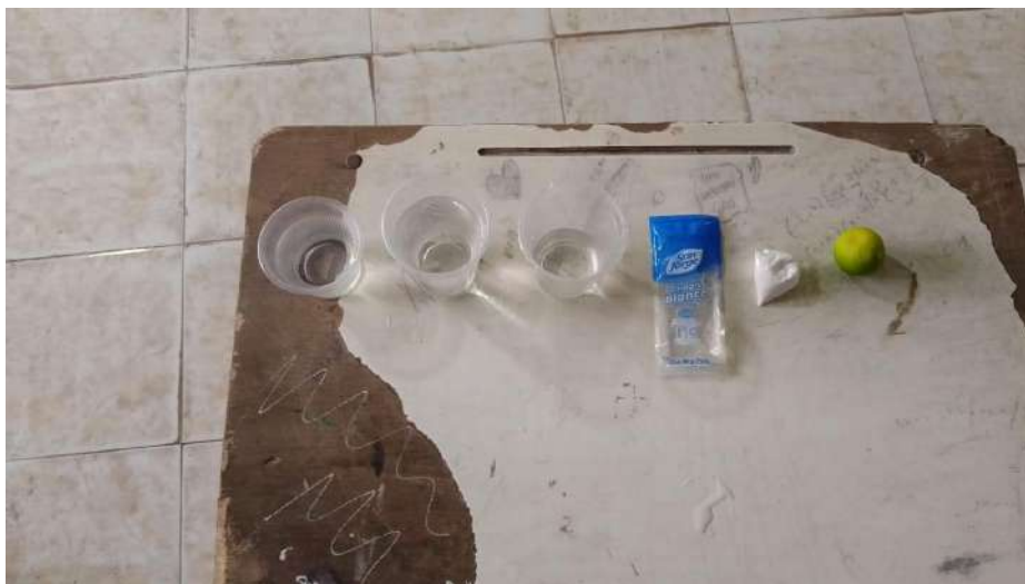
Fig. 62 Materiales para la creación de las sustancias líquidas con niveles diferentes de pH (agua, agua con limón y/o vinagre de frutas, agua con sal y/o bicarbonato de sodio) para las pruebas del sensor de pH mejorado.
