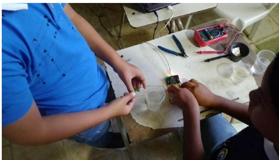
Fig. 72 Aprendices de la Tecnoacademia SENA del colegio IETAC haciendo las pruebas con el sensor de pH mejorado e ingresando el voltaje eléctrico de salida a una de las entradas analógicas de la tarjeta Micro:bit para obtener el valor del pH resultante visualizado en la matriz de LED's de la misma.
