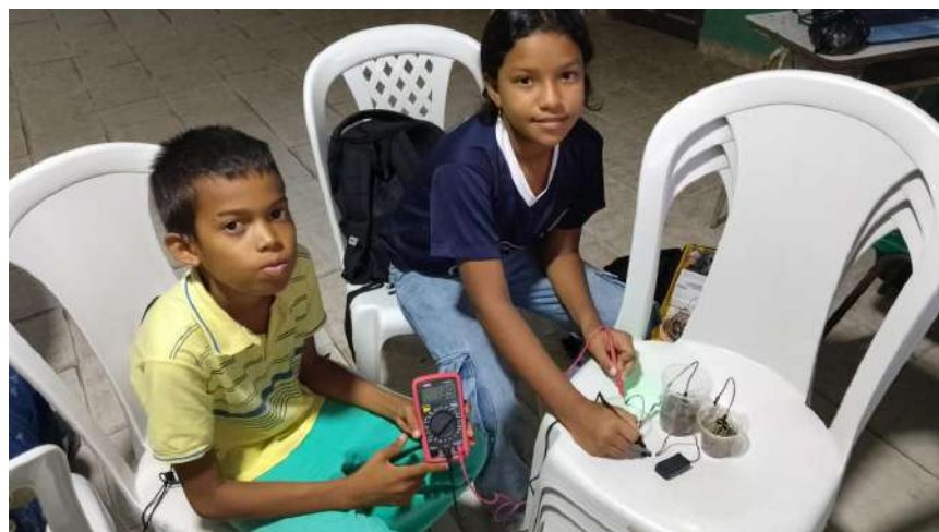
Fig. 47 Aprendices de la Tecnoacademia SENA del colegio IETAC que realizaron pruebas eléctricas con el sensor de humedad de suelo, midiendo el voltaje de salida con un multímetro digital para cuando el sensor se coloca en tierra húmeda.
