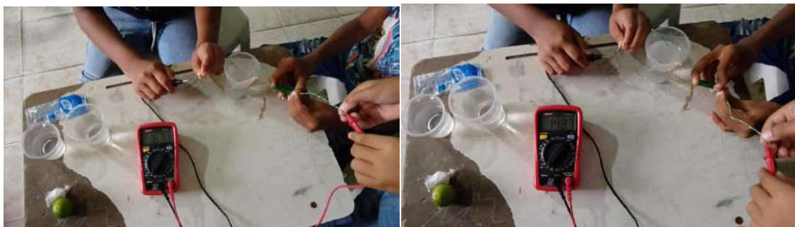
Fig. 65 Medición de los voltajes eléctricos resultantes para una sustancia líquida con pH ligeramente alcalino (agua + bicarbonato sodio), el cual se coloca con dos polaridades de conexión de una batería externa tipo AA.
