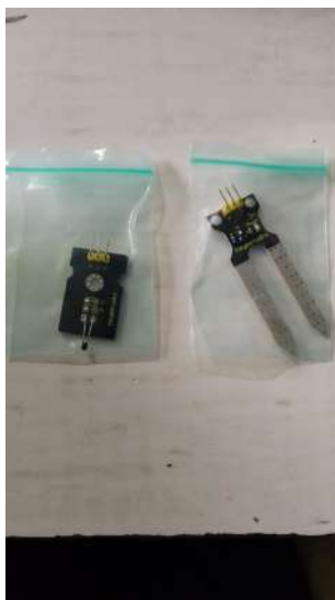
Fig. 5 Sensores de temperatura y humedad de suelo que incluyen dentro del kit de biotecnología de la Tecnoacademia SENA que nos entregaron a los facilitadores como material de formación
