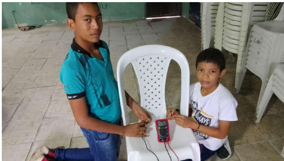
Fig. 59 Aprendices de la Tecnoacademia SENA del colegio IETAC tomando una medida de voltaje eléctrico con los materiales para los electrodos del sensor de pH (ej: alambres de cobre) para una sustancia liquida con un pH ligeramente alcalina ( \text{pH} > 7.0 , vaso agua con bicarbonato de sodio).
