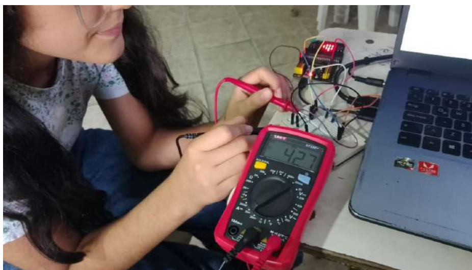
Fig. 76 Aprendices de la Tecnoacademia SENA del colegio IETAC haciendo las pruebas con el sensor de temperatura junto con la programación de la tarjeta Micro:bit para visualizar la temperatura interna de la misma y la medida por el sensor de temperatura en prueba.
