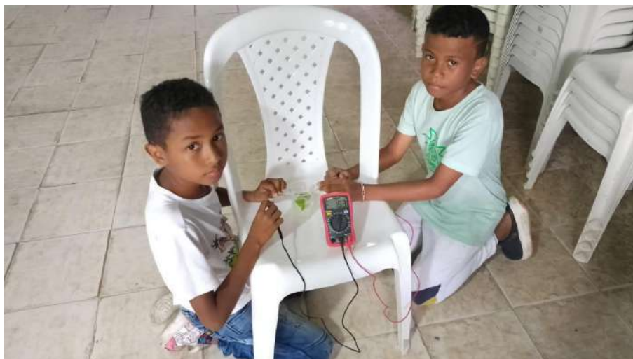
Fig. 55 Aprendices de la Tecnoacademia SENA del colegio IETAC tomando una medida de voltaje eléctrico con los materiales para los electrodos del sensor de pH (ej: alambres de cobre) para una sustancia liquida con un pH ligeramente ácido ( \text{pH} < 7.0 , vaso agua con limón).
