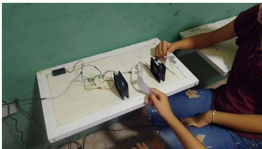
Fig. 74 Prueba del circuito driver de los ventiladores y/o extractores de aire funcionando ambos al mismo tiempo utilizando un transistor bipolar mejor para aumentar rendimiento del circuito driver.
