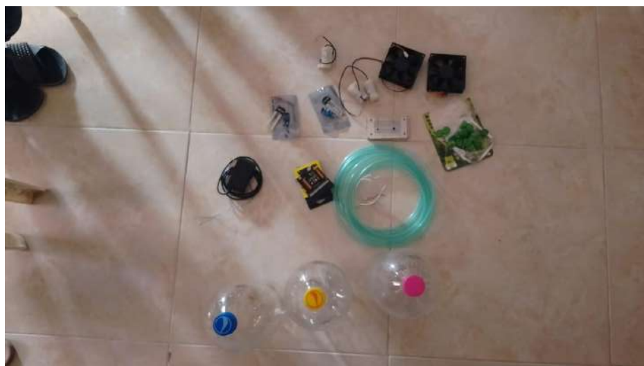
Fig. 82 Fotografía con la gran mayoría de elementos, partes y componentes que integran el sistema de control electrónico de variables medioambientales para el invernadero inteligente, en el que vemos las minibombas sumergibles, los sensores de humedad, los sensores de temperatura, los ventiladores y/o extractores de aire, las pastillas de follaje como nutrientes del suelo, el adaptador AC/DC para energizar los circuitos drivers, la tarjeta de expansión Micro:bit, las mangueras plásticas transparentes para el transporte de las sustancias líquidas para control pH y los tanques reservorios almacenar dichas sustancias líquidas del control de pH.
