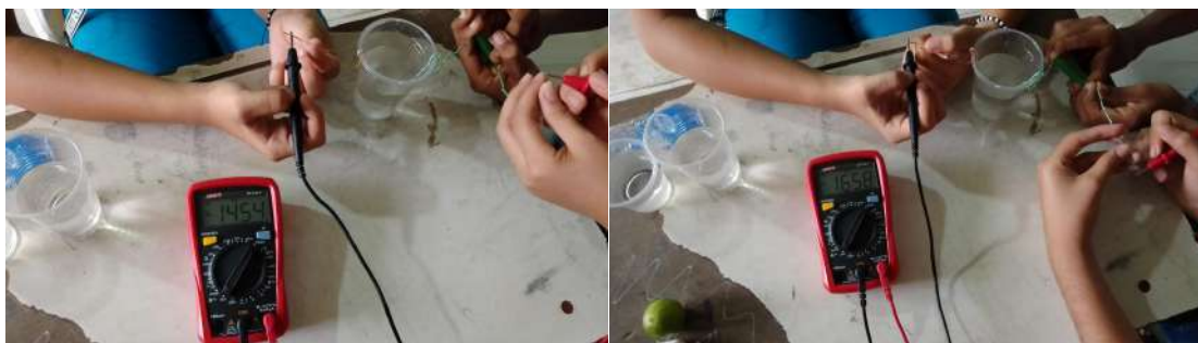
Fig. 63 Medición de los voltajes eléctricos resultantes para una sustancia líquida con pH ligeramente ácido (agua + vinagre frutas), el cual se coloca con dos polaridades de conexión de una batería externa tipo AA.
