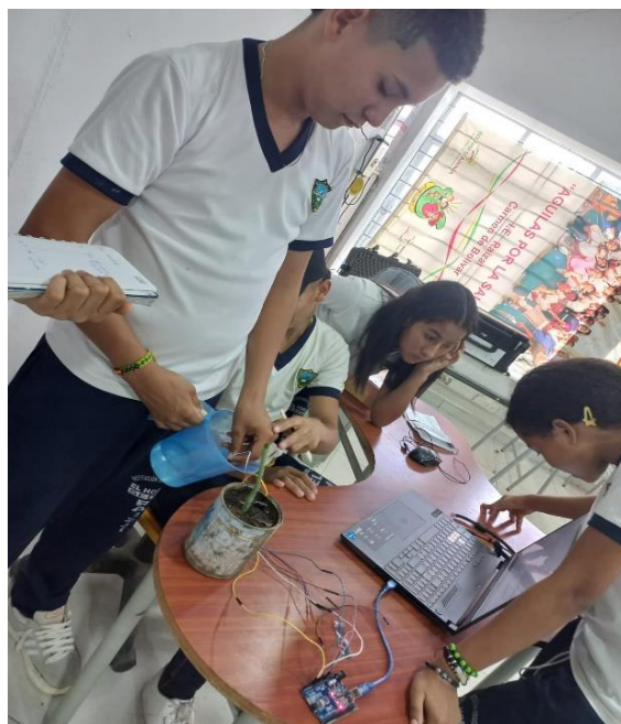
Figura 5. Aprendices caracterizando los sensores de humedad en condiciones de suelo completamente seco y muy húmedo.
