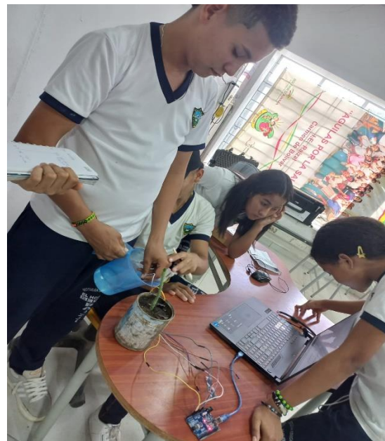
Figura 7. Aprendices caracterizando los sensores de humedad en condiciones de suelo completamente seco y muy húmedo.
