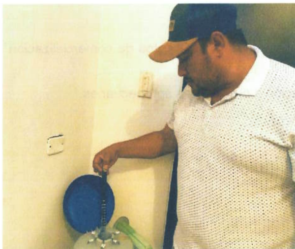
15-Medición del Nitrógeno del termo de conservación del material genético
