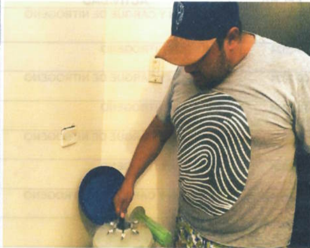
18-Medición del Nitrógeno del termo de conservación del material genético
