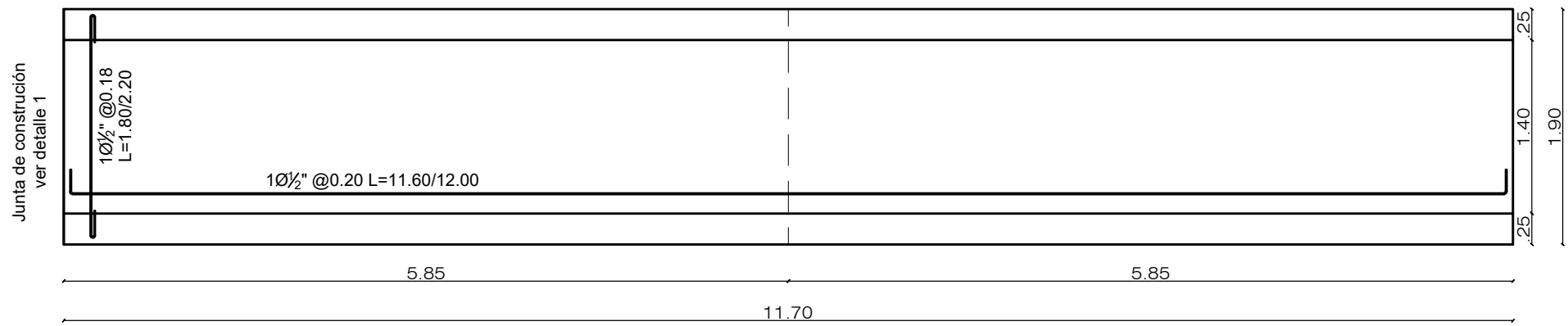
DETALLE REFUERZO INFERIOR LOSA FONDO BOX 1.40X0.90
