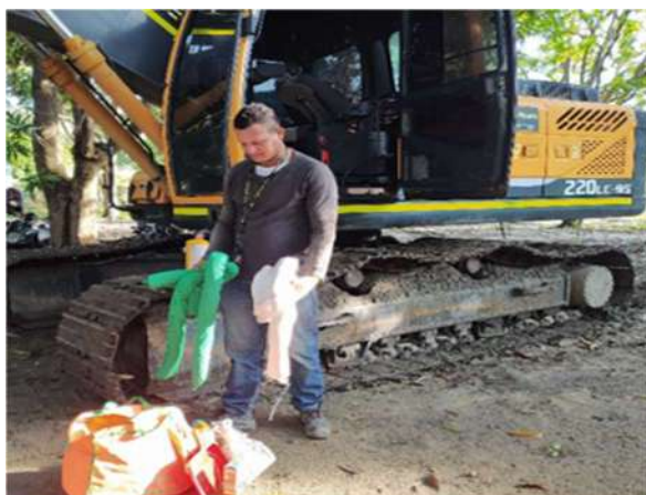
Figura 11: Kits para el control de derrames.
