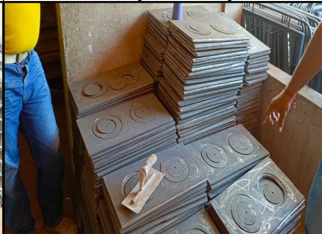
Foto 10. Seguimiento a los materiales de construcción (planchas) de las estufas ecoeficientes en bodegas del contratista Agua Luna.
