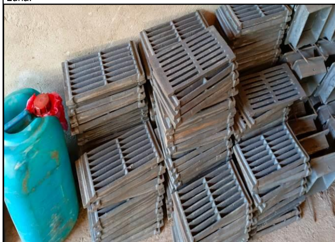
Foto 07. Seguimiento a los materiales de construcción (Parrilla interna) de las estufas ecoeficientes en bodegas del contratista Agua Luna.
