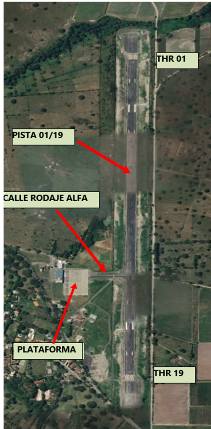
Ilustración 2. Vista general Aeropuerto Internacional Santa Ana. Fuente: Google Earth y elaboración propia
