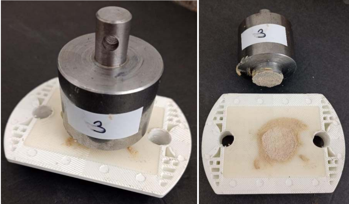
Figura 2. Presentación de una de las muestras previo al ensayo (imagen de la izquierda) y al finalizar el ensayo (imagen de la derecha)
