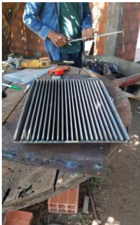
FOTOGRAFIA 1 Y 2: PROCESO DE CONSTRUCCION E INTALACION REJAS DE CRIBADO
