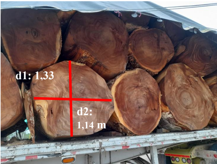
Fotografía 4. Metodología para el cubicaje de madera Rolliza. Fuente: Ing Forestal, James Ferley. Contratista Corpocesar 2024
