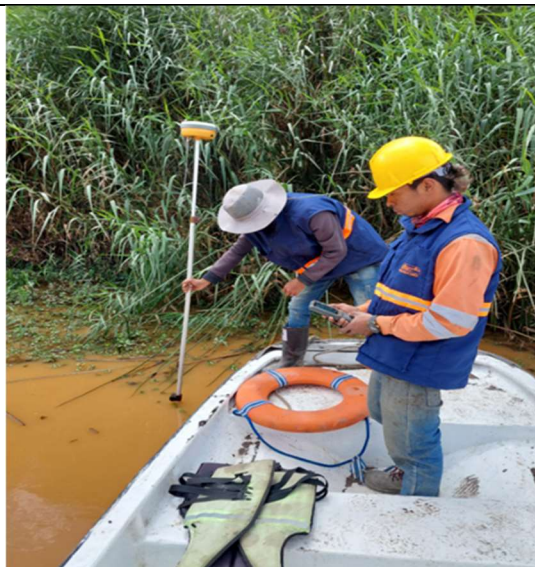
Ilustración 19 Levantamiento equipos RTK (F P)
